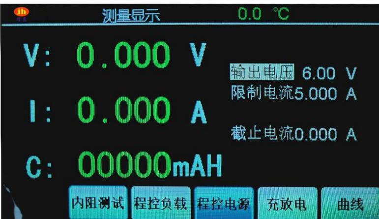
页面可以设置输出电压和限制电流
