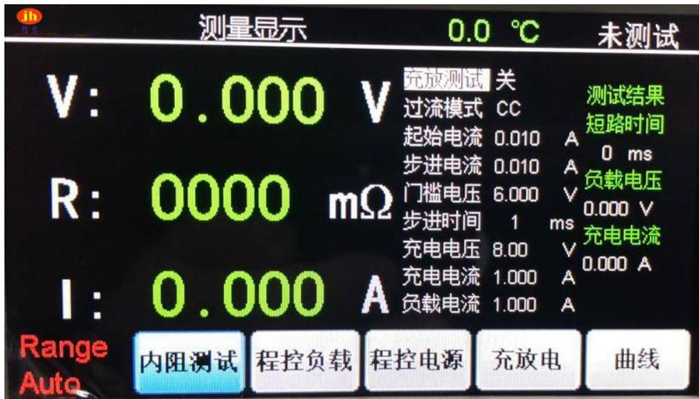
1. 内阻测试界面左下角显示的是当前内阻测试的档位状态，若显示为 AUTO，则档位自动切换；若显示为250mΩ，则说明当前测量的内阻范围为 0-250mΩ。若显示为 2000mΩ，则说明当前测量的内阻范围为 0-2000mΩ。三种状态通过档位键切换点来设置（此功能仅JH5530B 有）
