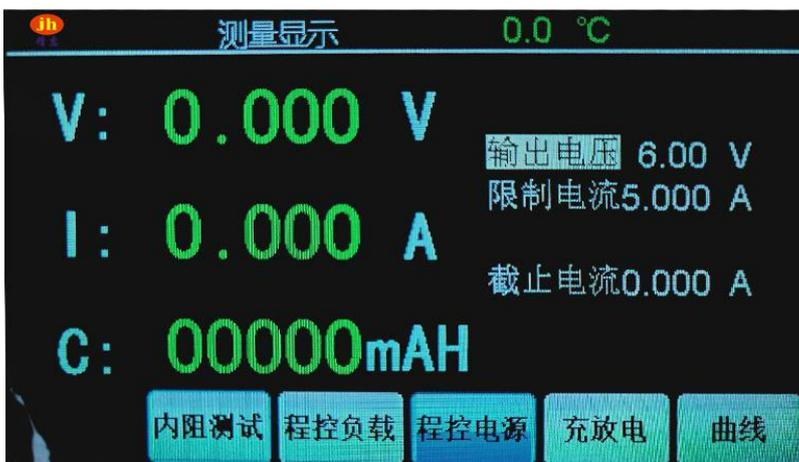
初次进入电源模式，默认为关机状态，按下确认键可以开启电源输出，再次按下确认键可以关闭输出。
