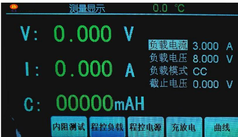
设置输出电压，按上下键光标移动到输出电压，按确认键后，光标会移到数字区域，再按数字键设定输入数值，按确认键即可完成设置，
