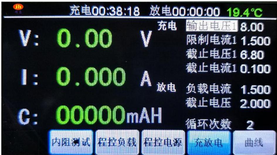
如果需要分步充电，建议用户第一步用大电流，第二步用小电流，第三步用涓流。
